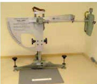
Klasifikacija mogućnosti klizanja, zasnovana na pendulum testu vrednosti:
